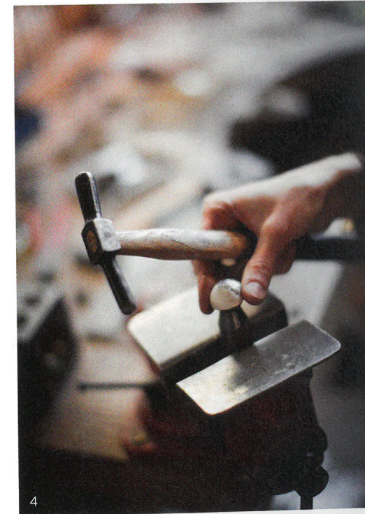
(1) Portrait dans l'atelier. (2) Bague Nid Explosion (pièce unique) en argent satiné. Les fils d'argent de sections très fines sont soudés les uns aux autres. (3) Croquis du pendentif Nid Cocon . (4) Martelage d'une demi-sphère à l'aide d'un marteau. (5) Bague de la collection Première Rosée en argent et pierres précieuses.
